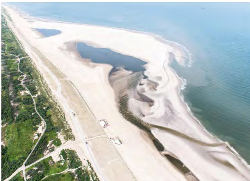
**Figura 97** Outro exemplo de construção de duna com recurso a alimentação artificial de areias, desta vez usando a técnica Zandmotor na costa do Mar do Norte, em Ter Heijde, na Holanda<sup>47</sup>.
