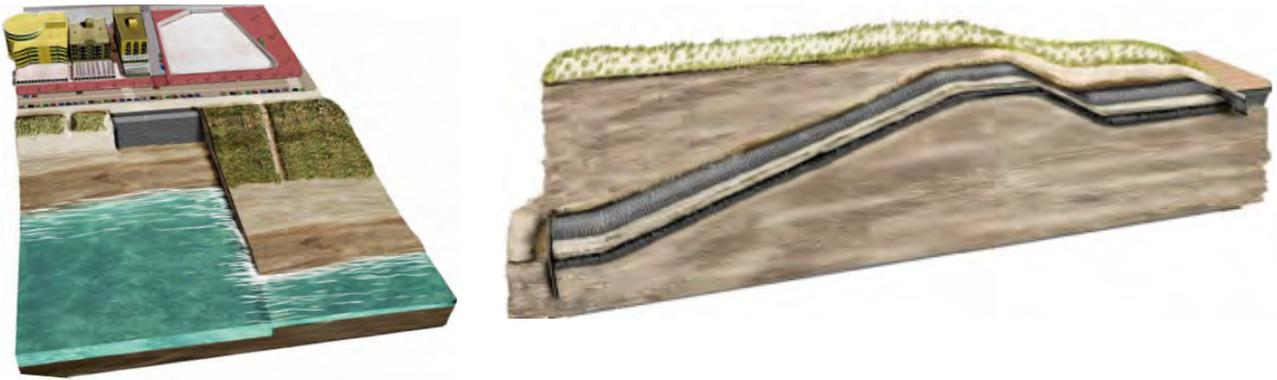
**Figura 96** Exemplo de construção de dike-in-dune em Noordwijk, Holanda. Um dique foi construído e coberto com areia, criando novas dunas e ampliado em cerca de 40 metros a linha de costa em direção ao mar<sup>46</sup>
